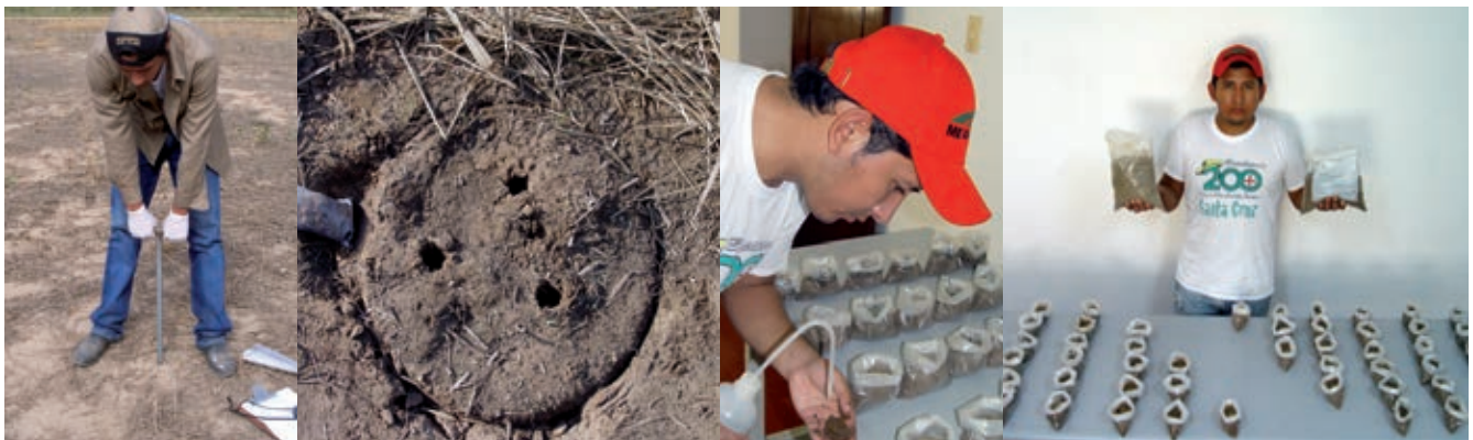
Imágenes 28-29-30- 31.- Formas de tomar las submuestras con un barreno helicoidal y su posterior clasificación mediante el método de texturación al tacto.
