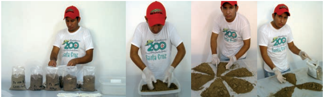
Imágenes 15-16-17-18.- Muestreo en grilla; Identificar las sub muestras que tengan la misma textura y coloración, mezclarlos en un recipiente y homogeneizarlos, sobre una meza y encima de una bolsa de plástico proceder al cuarteamiento, un lado de cada parte opuesta se retira y las otras se colocan en un nuevo embase bien identificado.
