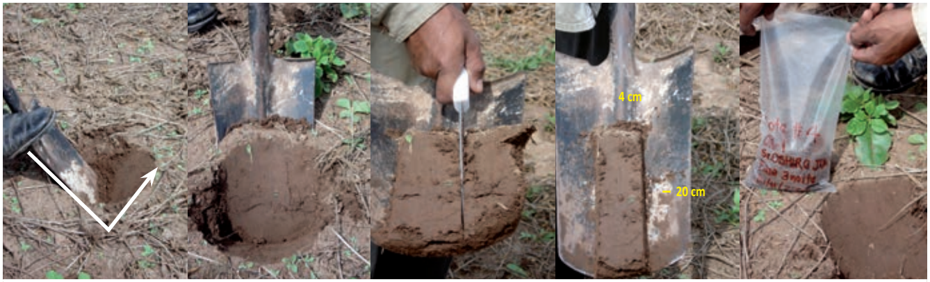
Imágenes 23-24-25-26-27.- Procedimientos del muestreo con pala.
